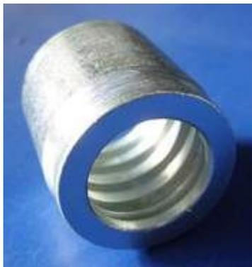
Обжимные муфты (или как их еще называют - «обжимки», «втулки», «кольца») предназначены для опрессовки рукавов высокого давления. При массовом производстве обжимные муфты изготавливаются из очень хрупкой и непригодной для деформаций под давлением автоматной стали, поэтому все муфты подвергаются после изготовления температурной обработке для повышения пластичности.
